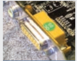
Gameport ili MIDI priključak nalazimo uglavnom na starijim zvučnim karticama
