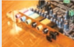
Ovisno o mogućnostima zvučne kartice, mijenja se broj priključaka za zvučnike
