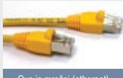
Ovo je mrežni (ethernet) priključak, modemski izgleda slično, ali je neznatno manji
