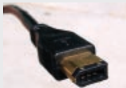
Preko Firewire priključka na kompjuter se uglavnom spajaju digitalni kamkorderi
