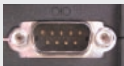
Serijski priključak poznat je i pod imenom COM port
